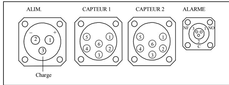
Les raccordements se font au dos du SCS6cD par des connecteurs JAEGER de différents types :
