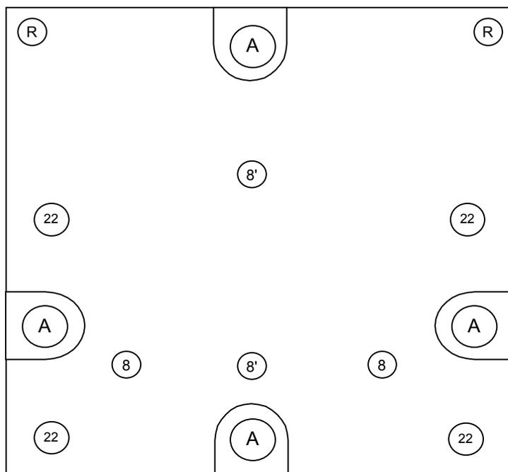
Ce type de platine est utilisable pour des capteurs 2 Hz ou 4,5 Hz.
