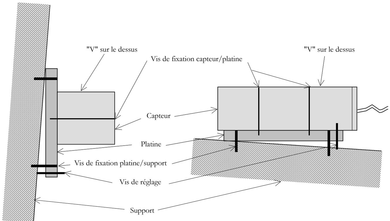
Lorsque l'emplacement du capteur est déterminé, vérifier l'état du support afin que rien ne vienne gêner la pose de la platine (aspérités, ...).
